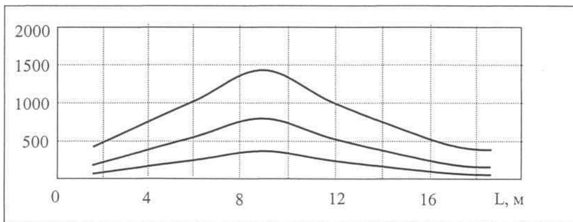
Рисунок. Зависимость плотности теплового потока  $Q$  при горении зданий и сооружений II степени огнестойкости.
